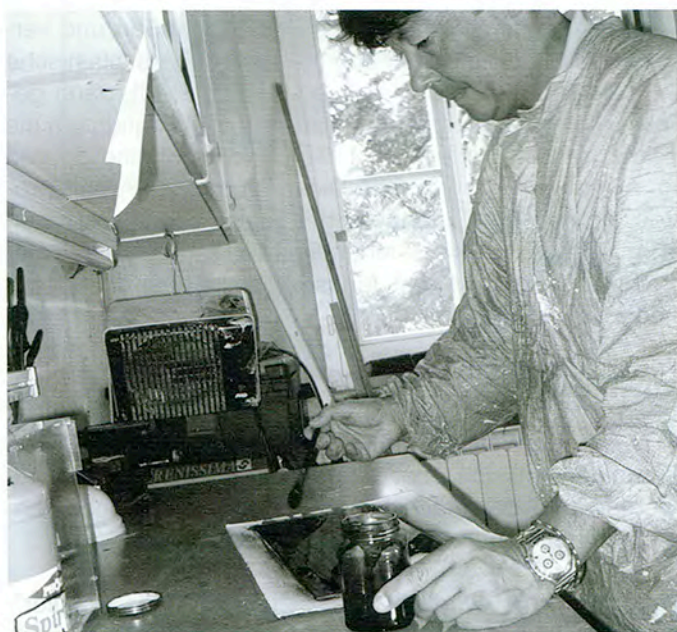
(4) Hier wird der Abdecklack aufgetragen
